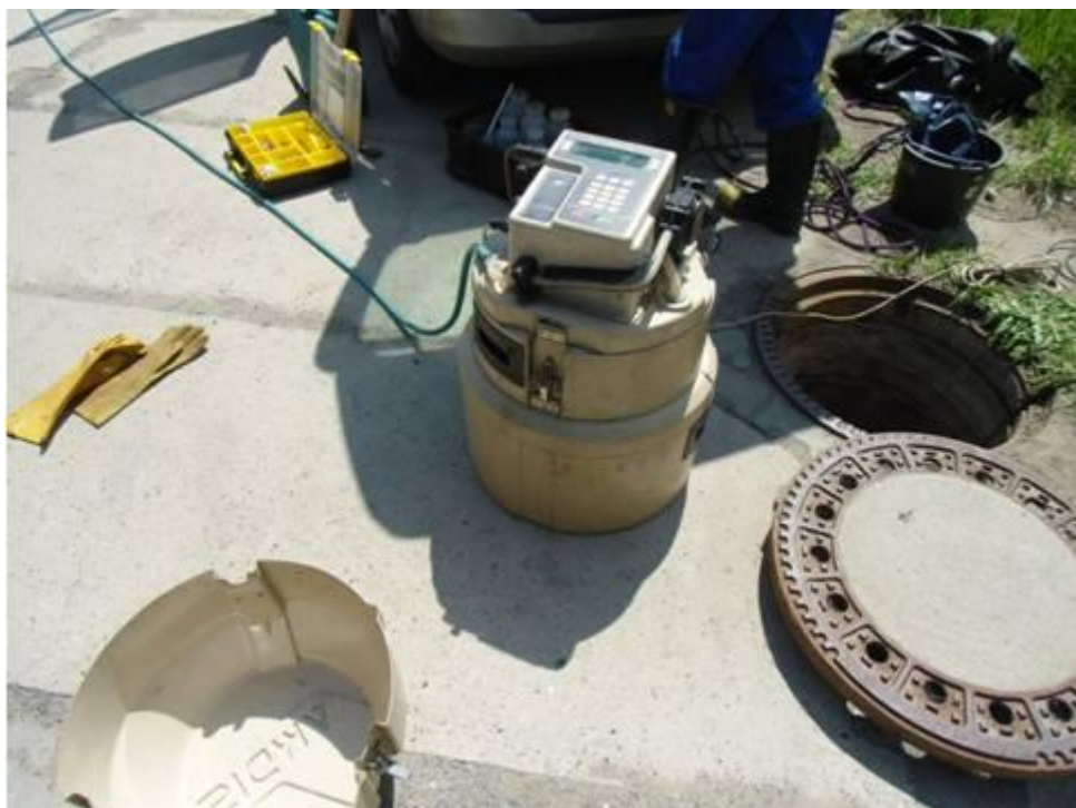
Obr. 4 Osazení měrného žlabu a umístění měřicích sond
