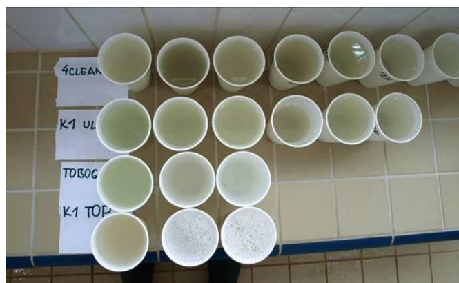
Obr. 1 Odběry vzorků odpadní vody při čištění stěn a dna nádrže bazénu.
