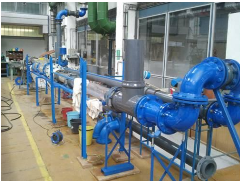
Obr. 1 Model trubní odlehčovací komory
